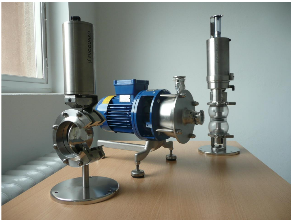
Klappe und Doppelsitzventil Evoguard / Krones sowie Pumpe Grundfos
